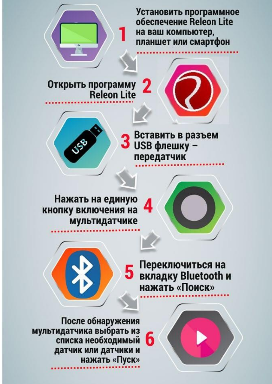
Рис. 6. Алгоритм работы с программным обеспечением Releon Lite
